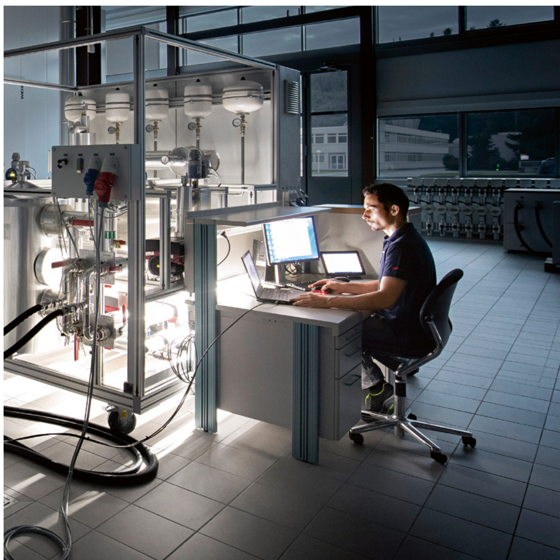
Prüfstand für Wärmepumpen mit Klimakammer
